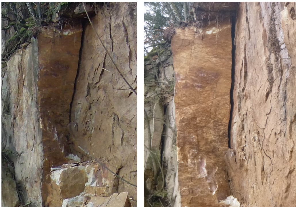
Detail rozevřené svislé trhliny ve skalním bloku v posici V-1 (foto 28.02. resp. 15.03.2021)
