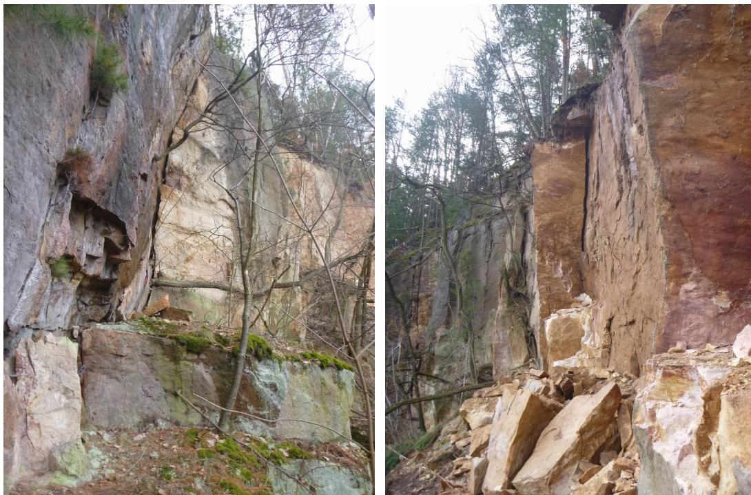
Pohledy na kriticky labilní blok V-1 skalní stěny (foto 15.03.2021)
